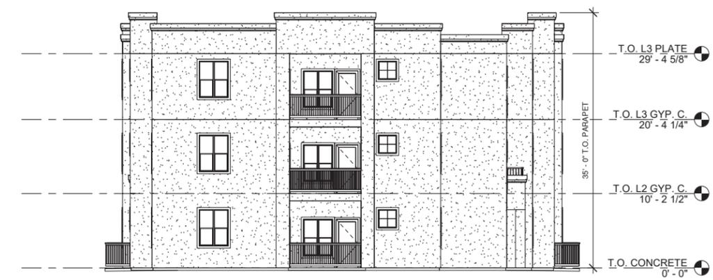
2 RIGHT ELEVATION - BLDG. TYPE A
